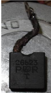
Fig 12 balai de puissance, marqué Paris-Rhône, balai d'origine ?
