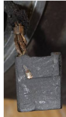
Fig 13 troisième balai, grossièrement saboté par un bidouilleur (ajusté à la disquette ?)
